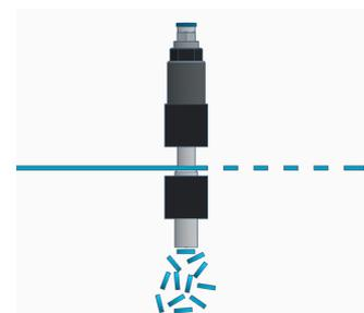
*Sistema de vacío conectado a la parte inferior de las unidades de perforación*
