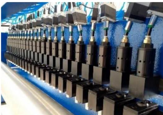
Este aparato **OCUPA POCO ESPACIO** y está diseñado para realizar **MACRO AGUJEROS** de varios diámetros y formas en **PELÍCULAS EN MOVIMIENTO** y, en particular, funciona con **PELÍCULA SIN IMPRESIÓN O IMPRESA**. Este modelo de PU debe integrarse en plantas existentes como extrusoras, máquinas de soldar, cortadoras etc.
